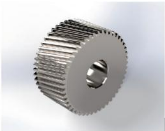
齿轮材料选用高级的铬钼钒合金钢，采用先进的真空等离子氮化工艺，将齿轮表面硬度提升至1200HV，中心硬度调质到30HRC，以获得最佳的耐磨耗及耐冲击韧性
