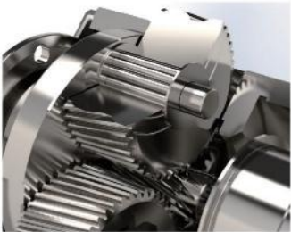
齿轮的传动介面采用不含保持架的满针滚针轴承，增加接触面积以提高架构刚性及输出扭矩
