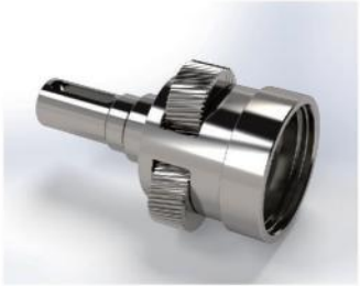
行星架与输出轴采用一体式的结构设计，提高结构紧凑度的同时，确保最大的扭转刚性
