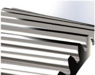
通过对螺旋齿面作齿形及导程修整，以降低齿轮对啮入及啮出的冲击和噪音，使齿轮啮合过程更加平顺，增加齿轮系的使用寿命
